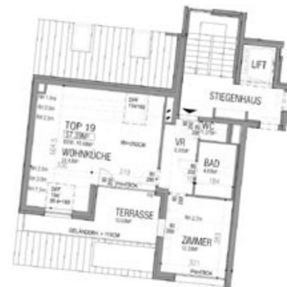
Oben: Grundriss einer 2-Zimmer-Wohnung mit 57,39 m 2 ; unten: Grundriss einer 4-Zimmer-Wohnung mit 97,27 m 2
